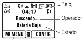
Icono de tecla de función izquierda Icono de tecla de función derecha
